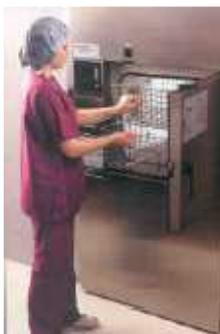
Fig. A5.6 La esterilización por Oxido de etileno es recomendable siempre y cuando sea automatizada.
