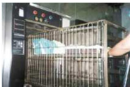
Fig. A3.2 Momento en que ingresa la carga a la cámara de vapor.
