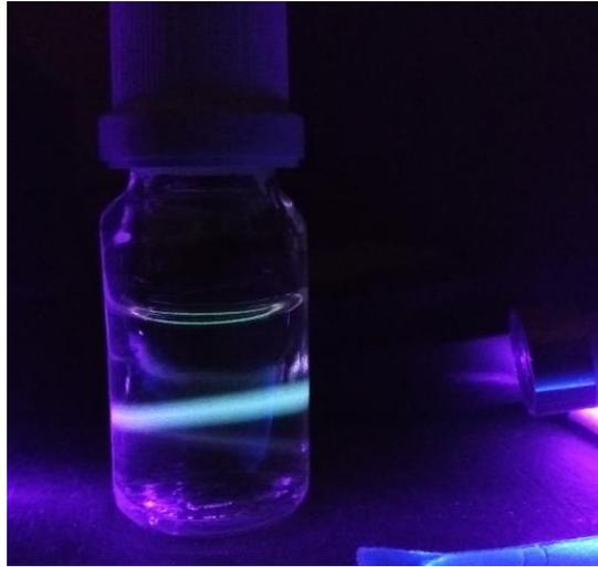
Figura 19. Suspensión coloidal irradiada con un láser de longitud de onda de 420 nm, se observa emisión luminiscente por la presencia de puntos cuánticos.
