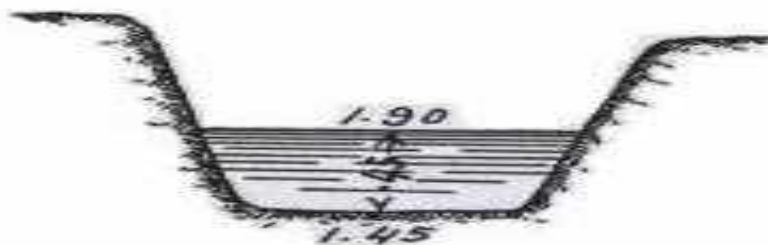
Corte transversal del canal de Cuauchichinola
