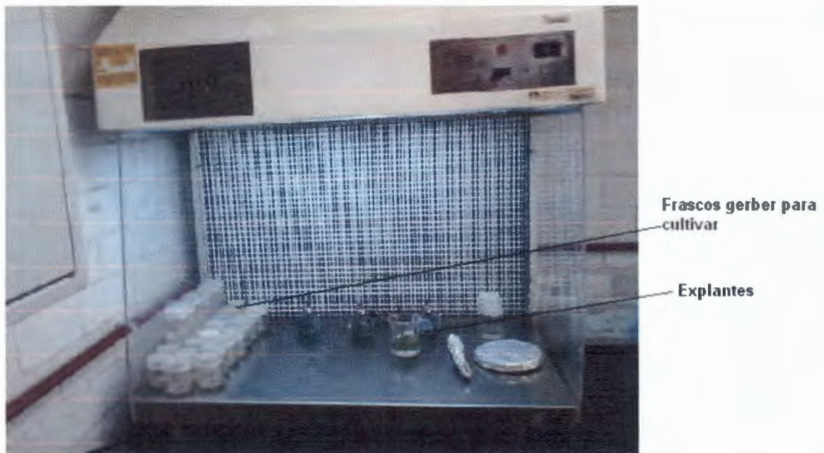
Figura 11. Condiciones asépticas de siembra en una campana de flujo laminar.
