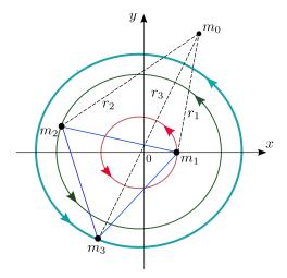
Figura 3.1: El problema restringido plano equilátero de cuatro cuerpos en un sistema de referencia sinódico.
