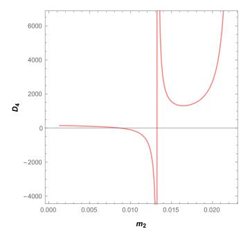
Figura 5.1: Gráfica de  $D_4$  en función de  $m_2$  con  $m_1 = 0.01$  para  $L_3$ . El valor de  $m_2$  donde  $D_4$  tiene una discontinuidad corresponde a la resonancia 2:-1, también existe un valor de  $m_2$  donde  $D_4 = 0$ .
