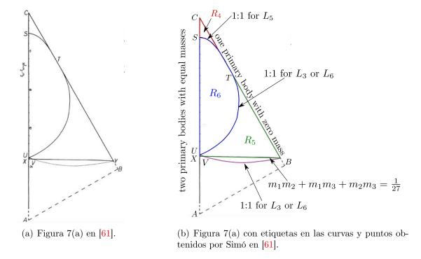
Figura 4.19: La región CYVX es el área de estabilidad lineal de los primarios en el espacio de masas, donde  $R_4 = CST$ ,  $R_6 = CUT$  y  $R_5 = CUVY$  son las regiones de estabilidad de los puntos de equilibrio  $L_5$ ,  $L_3$  and  $L_6$ .
