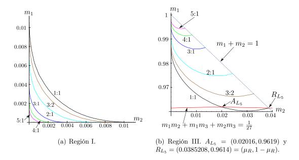
Figura 4.13: Curvas de resonancia para el punto  $L_5$  en las regiones I y III.
