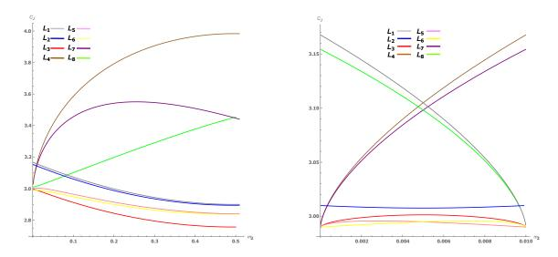
Figura 4.5: Evolución de la constante de Jacobi  $C_J$  para cada punto de equilibrio en función de  $m_2$  para  $m_1 = 0.01$  (izquierda) y  $m_1 = 0.99$  (derecha).
