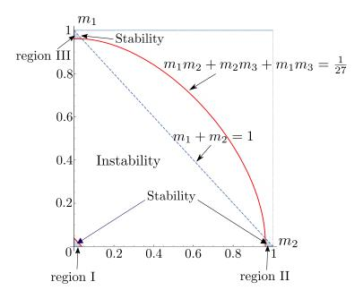
Figura 4.9: Regiones de estabilidad de la configuración de Lagrange (sombreado) e inestabilidad (región en blanco que esta por debajo de la línea  $m_1 + m_2 = 1$ ). El valor de la tercer masa es  $m_3 = 1 - m_1 - m_2$ . Las curvas en rojo corresponden al valor crítico de Routh.
