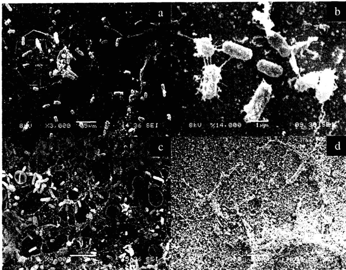
Fig. 5.2.1. Aspecto de biopelícula con SEM. a) Cultivo con tolueno sobre PVC. b) Cultivo con tolueno sobre vidrio. c) Cultivo con glucosa sobre polipropileno. d) Estructura y colonización de biopelícula con glucosa sobre polipropileno.
