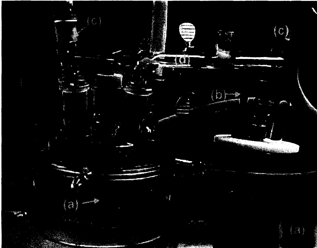
fig. 2.2. Celda electroquímica para la electrolixiviación masiva de un concentrado de galena con ánodo de bolsa de grafito. (a) ánodo de bolsa de grafito, (b) electrodo auxiliar (barra de grafito), (c) electrodo de referencia y (d) puente salino.
