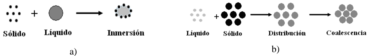
Figura 1.13. Dependencia del proceso de nucleación sobre el tamaño relativo entre la gota de líquido y sólido, a) proceso por inmersión, b) proceso por distribución (Iveson et al., 2001).
