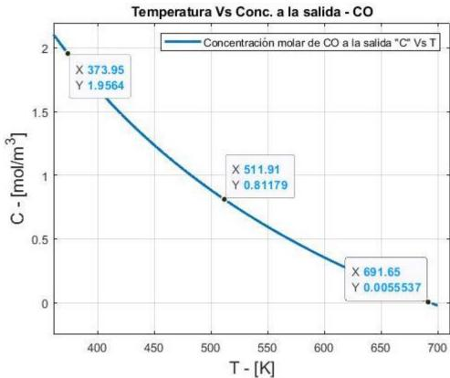
**Grafica 6**. Diagramas de Van Heerden y la curva de concentración de CO a la salida del reactor con el coeficiente de transporte de calor multiplicado por el factor un 0.003  $(1.19x10^{-5}\frac{kJ}{sK})$ .
