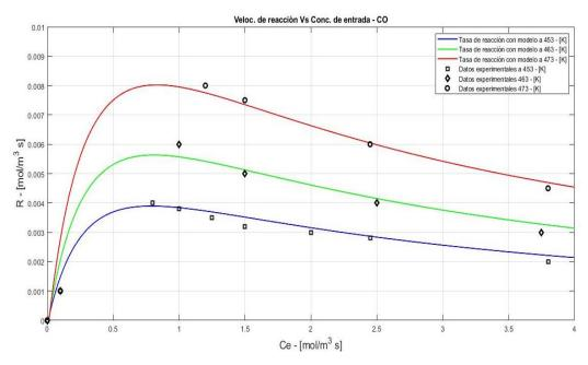
**Grafica 3.** Velocidad de reacción en función de la concentración molar de entrada de CO a tres diferentes temperaturas: 453, 463 y 473 K.
