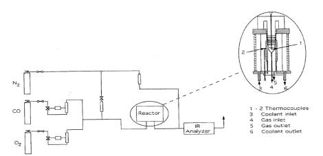
**Figura 1**. Esquema representativo de un reactor de tanque agitado continuo (CSTR), Baratti, (1992).
