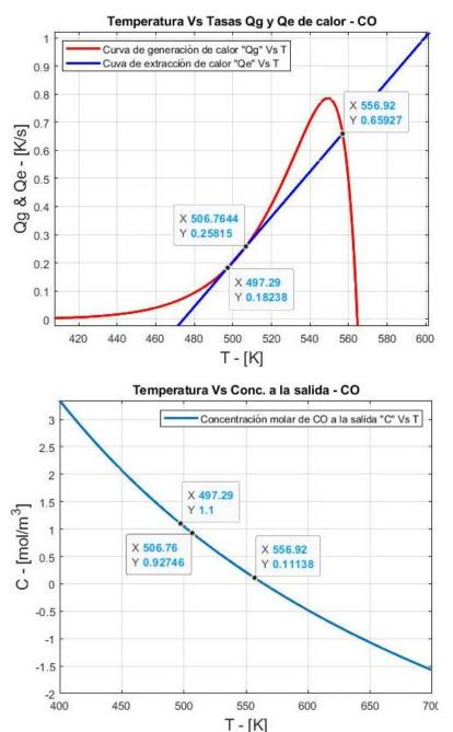
**Grafica 9**. Diagrama de Van Heerden y la curva de concentración de CO a la salida del reactor con el calor de reacción de la oxidación de monóxido de carbono entre la capacidad calorífica de los sólidos con un valor de  $11.825 \frac{m^3}{Kmol}$ .
