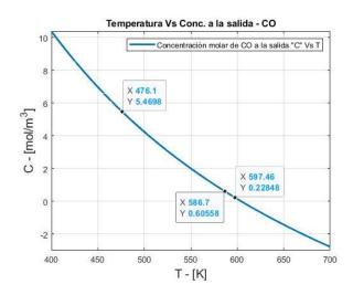
**Grafica 7**. Diagrama de Van Heerden y la curva de concentración de CO a la salida del reactor con la concentración de alimentación de monóxido de carbono del reactor con un valor de  $C_e = 9 \frac{mol}{m^3}$ .
