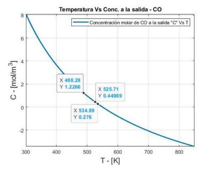
**Grafica 10**. Diagrama de Van Heerden y la curva de concentración de CO a la salida del reactor con el calor de reacción de la oxidación de monóxido de carbono entre la capacidad calorífica de los sólidos con un valor de  $9.933 \frac{m^3}{Kmol}$
