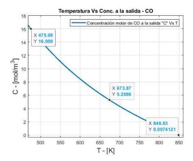
**Grafica 8**. Diagrama de Van Heerden y la curva de concentración de CO a la salida del reactor con la concentración de alimentación de monóxido de carbono del reactor con un mol
