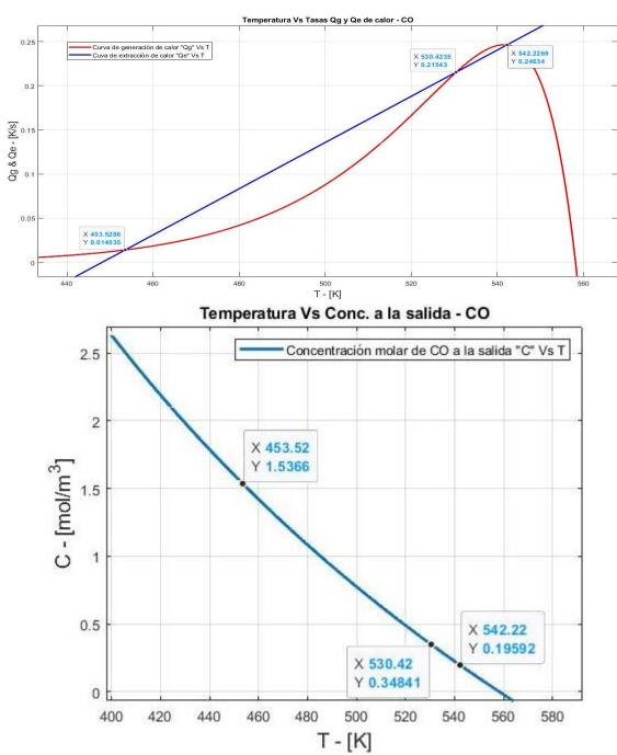
**Grafica 5**. Diagramas de Van Heerden (arriba) y la curva de concentración de CO a la salida del reactor (abajo) con el coeficiente de transporte de calor nominal multiplicado por un factor de 0.285 ( $0.68x10^{-5}\frac{kJ}{sK}$ ).
