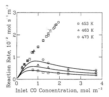
**Figura 3.** Velocidad de reacción en función de monóxido de carbono de entrada a tres diferentes valores de temperatura, *Baratti et al.*, 1992.
