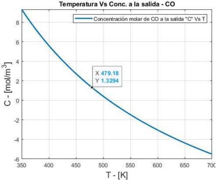
**Grafica 4**. Diagrama de Van Heerden en condiciones nominales de Baratti et al, (1992) y la curva de concentración de CO a la salida del reactor.
