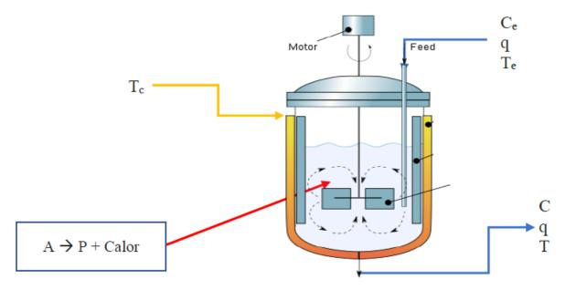
Figura. 2. Reactor de tanque agitado continuo con camisa de enfriamiento.
