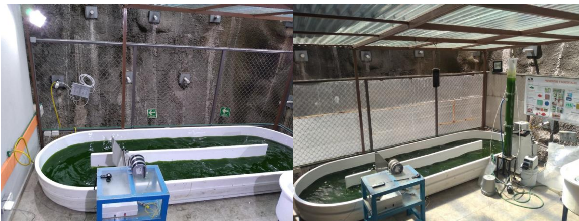
Figura 6.2. Fotobiorreactores para el cultivo de Scenedesmus obtusiusculus AT-UAM a) RWP y b) FBRH
