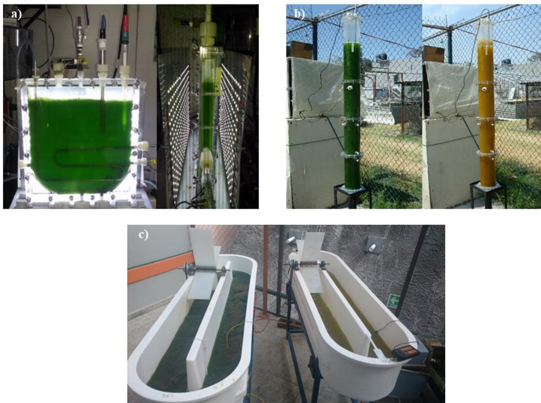
Figura 4.1. Fotobiorreactores para el cultivo de Scenedesmus obtusiusculus AT-UAM a) Fotobiorreactor de Placas Planas (FPP), b) Fotobiorreactor de columna de burbujeo (FCB) y c) Raceway pond (RWP).
