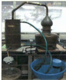
Figura 9. Sistema de destilación con recirculado de agua
