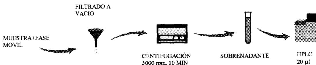
Fig. 5.4 Diagrama esquemático donde se muestran las operaciones para HPLC
