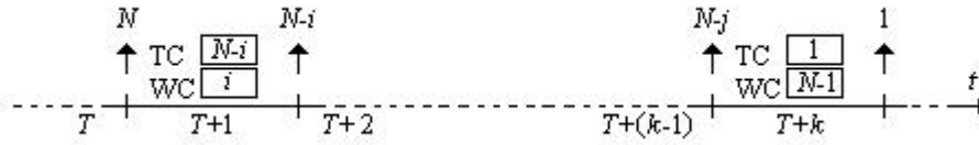
Figura 3.2: Política de realimentación por ranura. k representa el número de ranuras que le toma al sistema llegar a una transmisión con éxito después de una colisión de multiplicidad N . La estación central informa al final de cada ranura (representado por la flechas verticales), el número de estaciones en la celda de transmisión (que representa la multiplicidad de la colisión).
