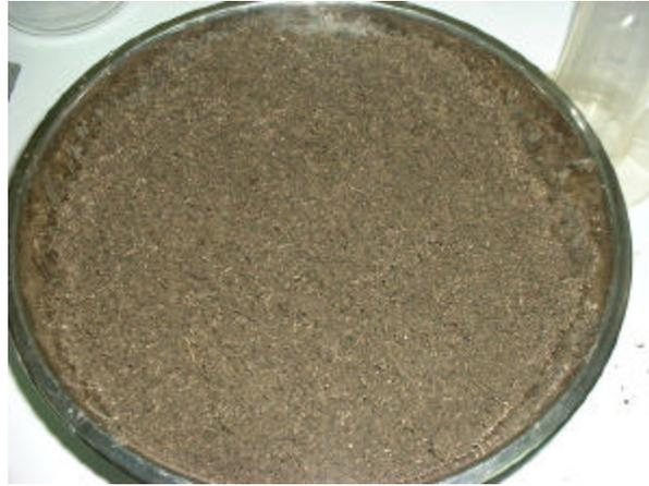
**Fig. 4.** Mezcla de suelo contaminado de Poza Rica, tamizado con bagazo de caña.
