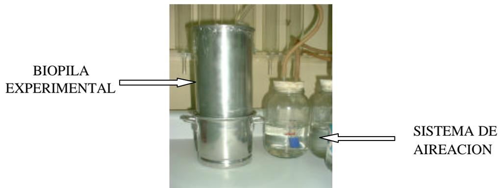
**Fig. 5.** Biopila experimental con la mezcla de suelo con el bagazo de caña.
