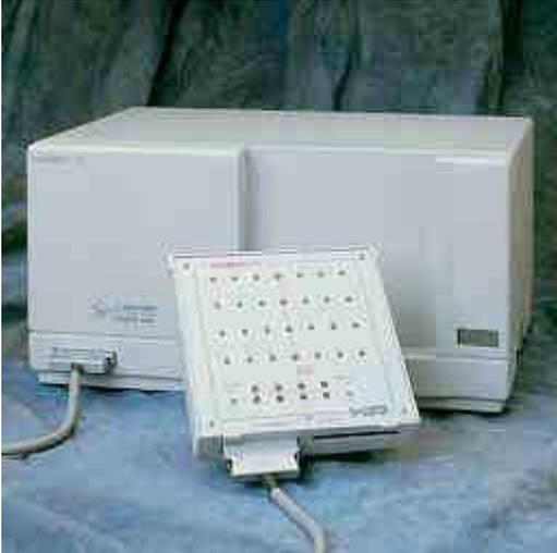
Los SYNAMPS contienen componentes analógicos necesarios para amplificar las señales neurofisiológicas de bajo nivel y los componentes digitales precisos para almacenar y digitalizar eventos externos, corregir la DC, filtrar digitalmente y transferir los datos al computador principal.
