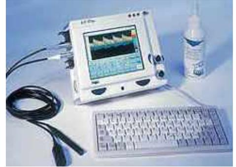
Cuando usted adquiere un EZ-Dop puede usted seleccionar dos frecuencias de las siguientes 2, 4 y 8 MHz, y ya sea un monitor TFT-color o LCD blanco&negro. Con ellos crear tu propio sistema Doppler. En general el sistema contiene un computadora PC compatible y un disco duro con una mínima capacidad de 4GB. Su operación es muy sencilla por medio de un botón-perilla que se encuentra en el aparato, o ya sea por medio de un control remoto, el cual es opcional
