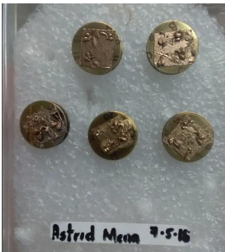
Figura 4. Polinarios en porta muestra y cubiertos con oro, listos para su observación en el MEB.
