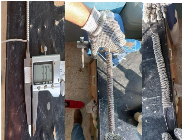
Figura 8. Proceso de creación de la resistencia eléctrica.
