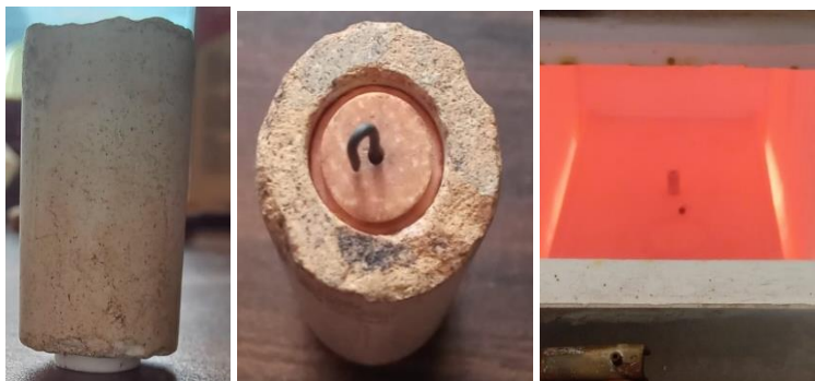
Figura 12. a) Crisol de alúmina b) Crisol con tapa de alúmina c) Crisol en mufla a 1000 °C.
