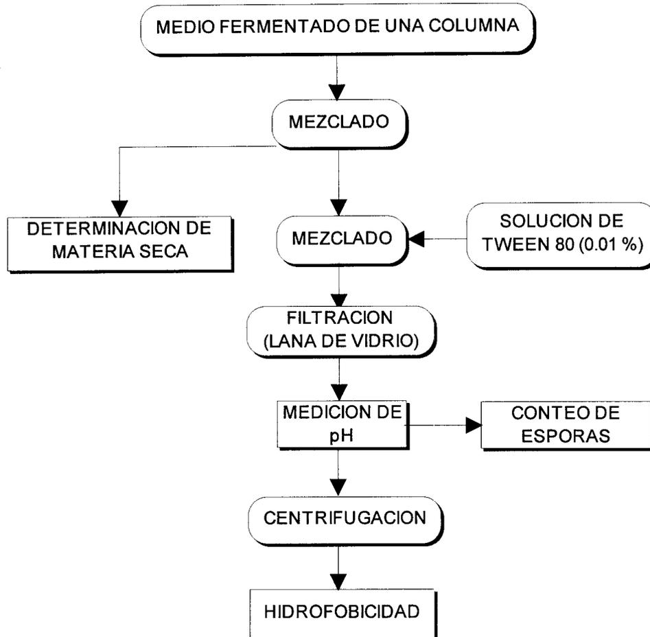
**Figura 4.5** Esquema de preparación y tratamiento de las muestras obtenidas de la FMS.
