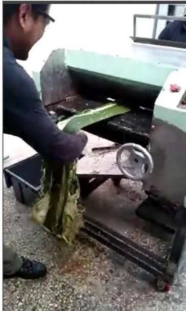
**Fig. 21** Desfibrado de la hoja de agave para la separación del jugo, fibra y pulpa
