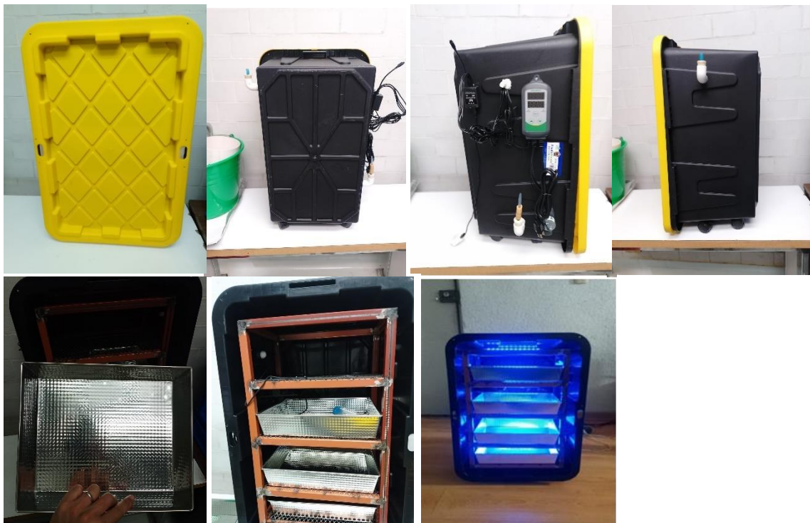
Figura 20. Diseño final del fermentador
