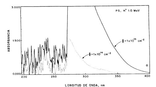
Fig. 18.- Espectros UV-Vis de películas de PS irradiadas con H<sup>+</sup> de 1.0 MeV a las afluencias indicadas. Se observa una absorción más intensa en la muestra más dañada.
