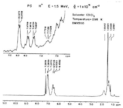
Fig. 21.- Espectro NMR de PS irradiado con protones a la energía y afluencia indicada, donde se observan señales correspondientes a estructuras policíclicas aromáticas.
