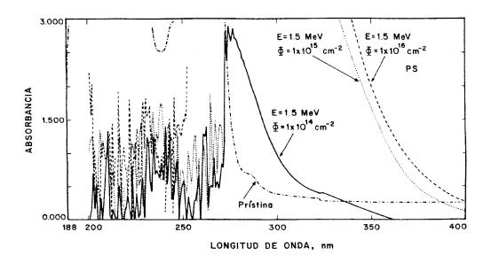
Fig. 19.- Espectros UV-Vis de PS prístina y bombardeado con protones de 1.5 MeV a las tres afluencias utilizadas en esta investigación.
