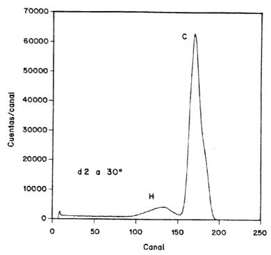
Fig. 30.- Espectro de los protones dispersados a un ángulo de laboratorio de 30°, donde se muestran los picos correspondientes a C e H, separados por cinemática, en la misma muestra de PS.
