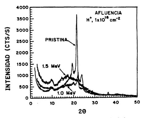
Fig. 6.- Difractograma de películas de PEBD bombardeado con protones de 1.0 y 1.5 MeV comparado con la prístina.
