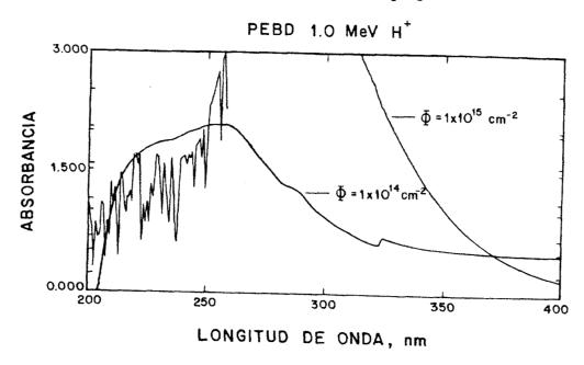
Fig. 5.- Espectros UV-Vis de blancos de PEBD bombardeados con H<sup>+</sup> de 1.0 MeV a dos afluencias distintas. Se observa el desplazamiento hacia la región visible del espectro de la muestra más dañada.
