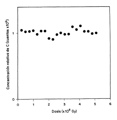
Fig. 31.- Variación de la concentración de C en la muestra más dañada de PS; datos obtenidos del espectro retrodispersado.
