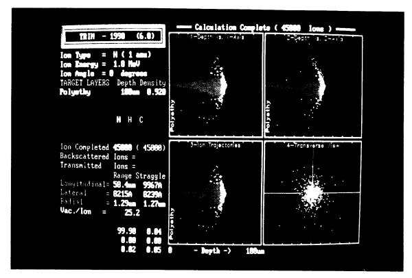
Fotografia 1.- Simulación mediante TRIM del alcance de H' de 1.8 MeV sobre PE.
