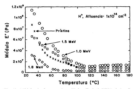
Fig. 12.- Módulos de almacenamiento E' de película de PEBD sin irradiar e irradiadas con protones a las energías indicadas y  $\Phi = 1 \times 10^{14}$  cm<sup>-2</sup>.
