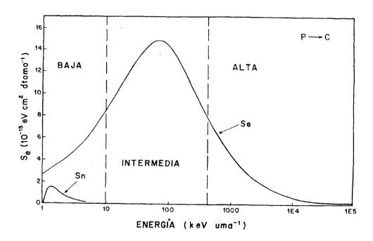
Fig. 1.- Curva típica del frenamiento electrónico y nuclear de protones incidiendo sobre un blanco de carbón, indicando las regiones de baja, intermedia y alta energía.
