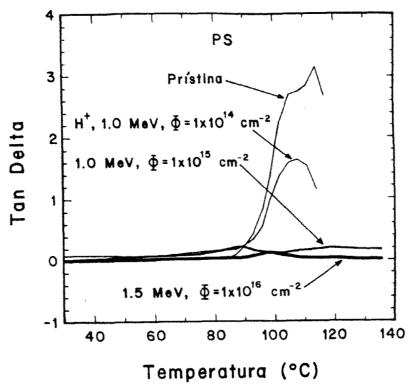
Fig. 27.- Efecto de la densidad de energía depositada por protones de las energías y afluencias indicadas, sobre la Tan  $\delta$  del PS.
