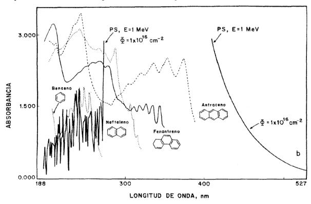
Fig. 20.- Absorción UV-Vis de compuestos policíclicos; el correspondiente al benceno se desplazó ligeramente para mayor claridad de la figura. Se incluye también el espectro correspondiente a la muestra irradiada con  $H^+$  de 1.0 MeV y  $\Phi = 1 \times 10^{16}$  cm<sup>-2</sup>.
