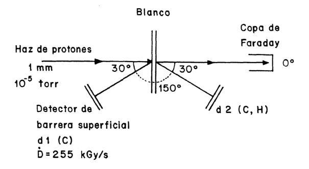
Fig. 2.- Arreglo experimental utilizado para la determinación de la concentración de C e H mediante la técnica ERDA.
