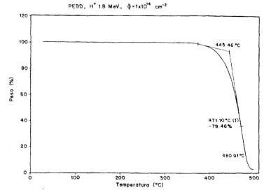
Fig. 10.- Termograma TGA de película delgada de PEBD, irradiada a una  $\Phi = 1 \times 10^{14} \text{ p cm}^{-2}$ , con energía de 1.8 MeV. La temperatura de descomposición inicial es de 445 °C.
