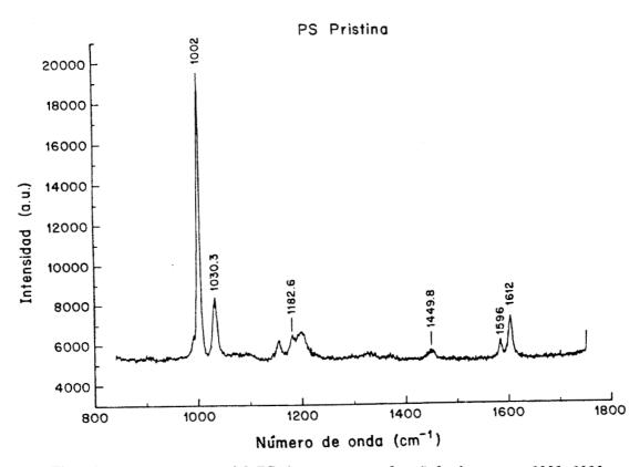
Fig. 24.- Espectro Raman del PS virgen, mostrando señales intensas a 1002, 1030 y 1612 cm<sup>-1</sup>.
