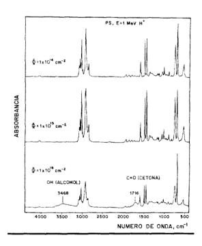
Fig. 16.- Espectros FTIR de PS irradiado con protones de 1.0 MeV a las afluencias señaladas.
