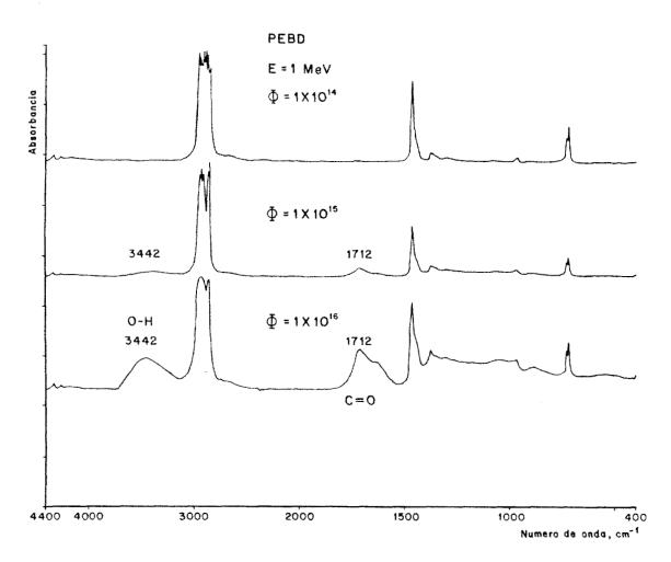
Fig. 4.- Espectros FTIR de PEBD bombardeado con protones de 1.0 MeV a las tres afluencias distintas seleccionadas para este estudio. Las bandas nuevas son más intensas en la muestra con mayor densidad de energía.
