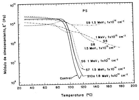
Fig. 28.- Módulos de almacenamiento de varias películas de PS bombardeadas con protones a las afluencias y energías señaladas, comparado con el correspondiente a la prístina.
