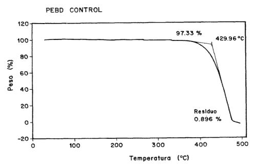
Fig. 9.- Termograma TGA de PEBD prístina, mostrando una temperatura de descomposición inicial de 430 °C.
