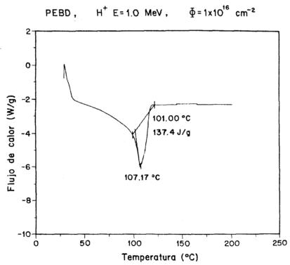
Fig. 8.- Termograma de PEBD bombardeado con protones de 1.0 MeV y afluencia de 1 x  $10^{16}$  cm<sup>-2</sup>, donde se observa una disminución de la  $\Delta H$ .
