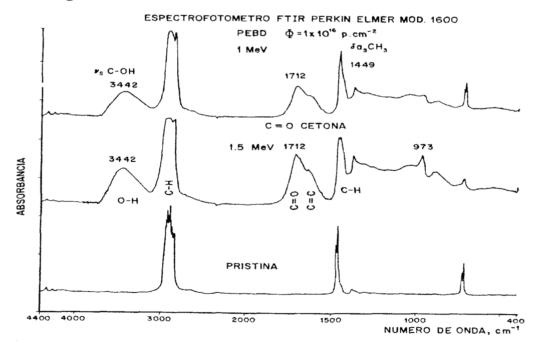
Fig. 3.- Espectros FTIR de películas delgadas de PEBD, control e irradiadas con protones a la afluencia y energías indicadas. En ellos se aprecia la aparición de bandas nuevas correspondientes a grupos OH, C=O, C=C.
