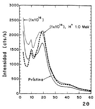
Fig. 26.- Difractogramas WAXS de películas de PS, prístina e irradiadas con protones de 1.0 MeV a las afluencias indicadas.
