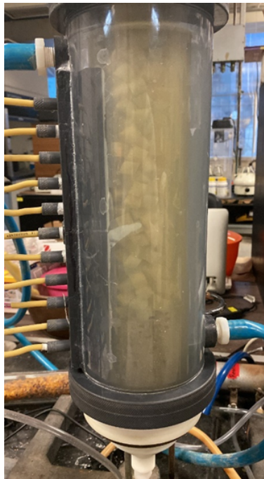
Figura 5.35: Biorreactor empacado con soporte inerte y Aspergillus terreus TUB F-154
