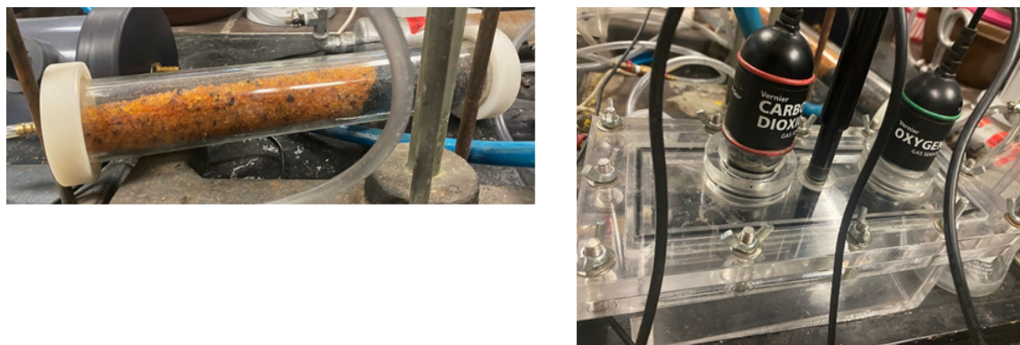
Figura 8.6: Tubo desecador con silica gel (derecha) y cámara de gases con sensores (izquierda).
