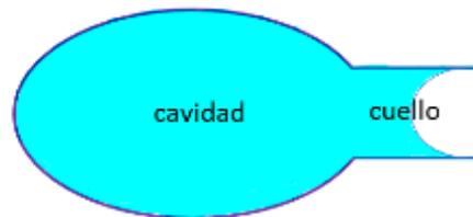
*Figura 2.5 Diagrama de la representación de un poro lleno de condensado capilar conectado por un enlace o cuello.*
