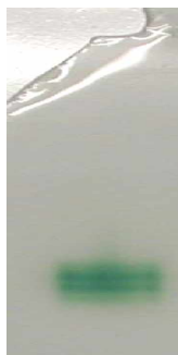
Figura 7. Zimograma de las lacasas parcialmente purificadas, con ABTS como sustrato.
