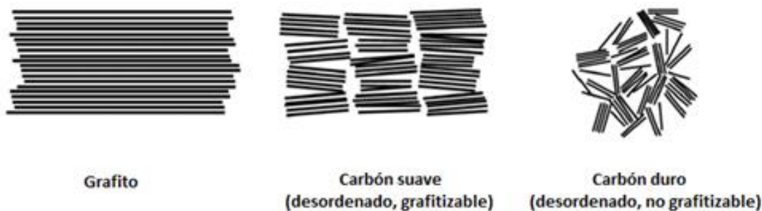
Figura 4.1: Esquema que ilustra las microestructuras del grafito, el carbono blando y el carbono duro.
